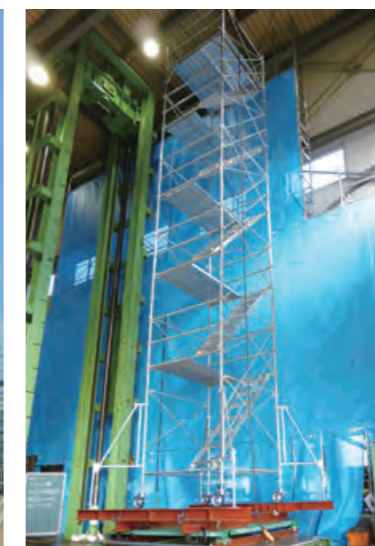
ローリングタワー使用時の安定性検証 傾斜実大実験
